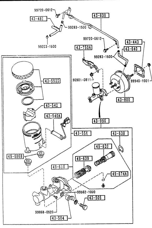
BRAKE MASTER CYLINDER & POWER BRAKE (W/O ANTI LOCK BRAKE)
