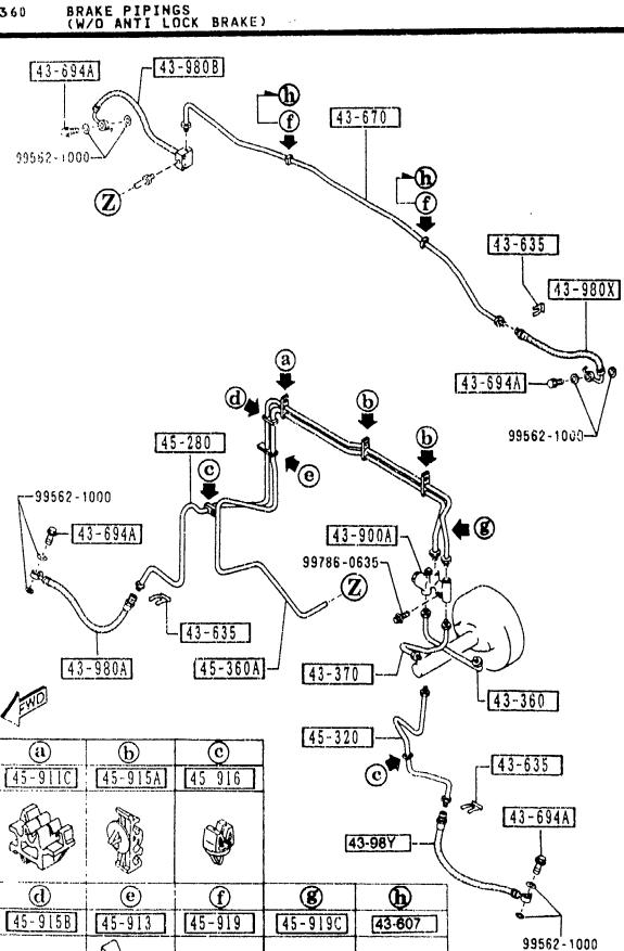
BRAKE PIPINGS (W/O ANTI LOCK BRAKE) 4360 -1
