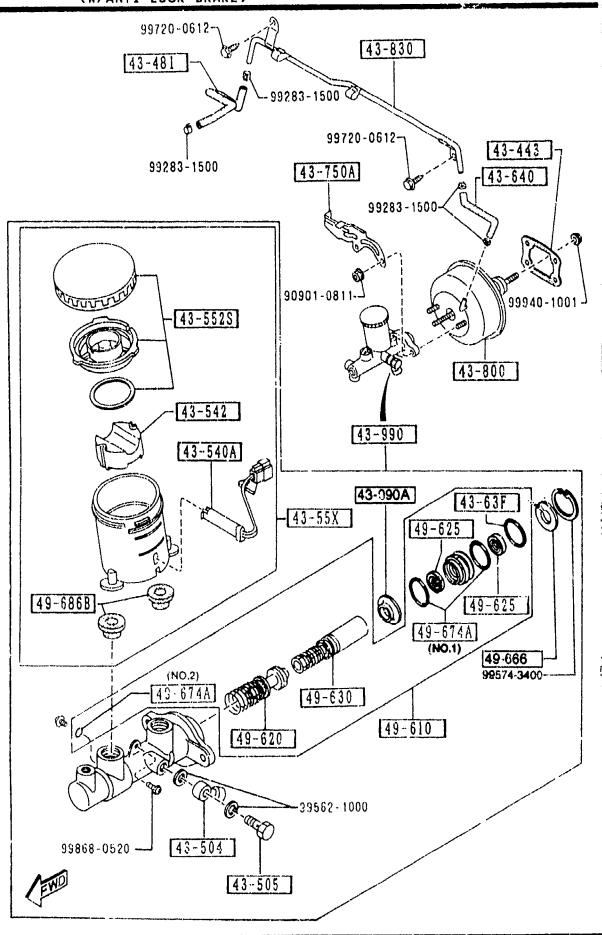
4340 A-2 \* BRAKE MASTER CYLINDER & POWER BRAKE (W/ANTI LOCK BRAKE)
