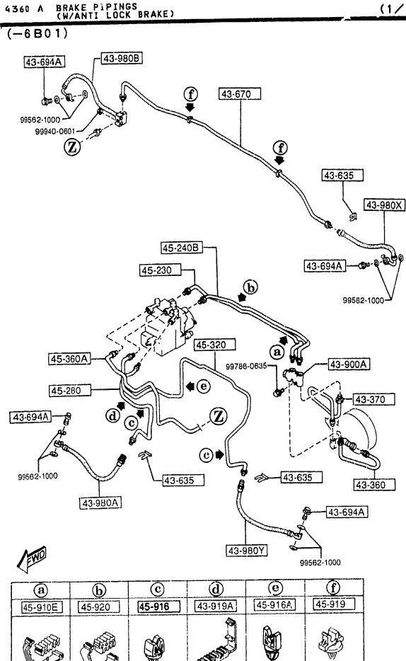
BRAKE PIPINGS (W/ANTI LOCK BRAKE) 4360 A-1
